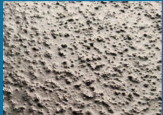
特别适用于客货车内的地面。Elycold Anti-Slip 防滑层压板由加入了石英的灰色胶衣组成。
